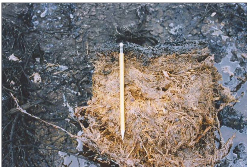
Рис.4. Нефтезагрязнённая торфяная олиготрофная почва. Под битуминизированной коркой залегают насыщенный нефтью сфагновый торф.
