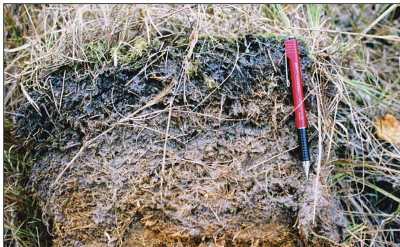
Рис.7. Вторично эвтрофизированная торфяная олиготрофная почва. На олиготрофном сфагновом торфе залегает современный эвтрофный торфяной горизонт.
